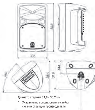
Отверстия под винты адаптера BMS-10A для крепления в микрофонную стойку (приобретается отдельно)
